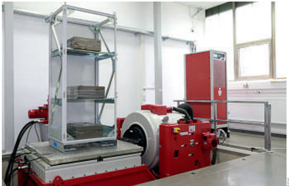
Erdbebensimulation: Im Rittal-Prüflabor lassen sich die Auswirkungen von Erdbebenschocks und -vibrationen simulieren. Hier ein Schaltschrank TS 8 mit Erdbebenkit
