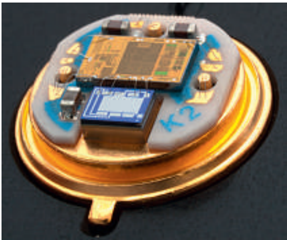
Die empfindlichen Sensorsignale werden über ultrakurze Wire-Bond-Drähte mit dem Signalkonditionierungs-IC verbunden
