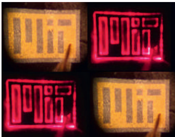
Das Bild zeigt LEDs, die auf Graphen gezüchtet und dann abgezogen wurden
