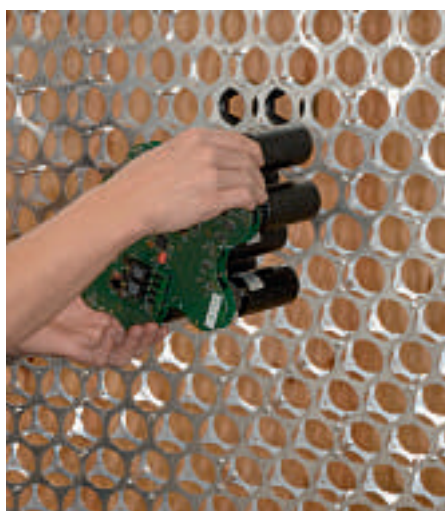
147 dieser Detektoren kommen in das riesige, 2 t schwere Kameragehäuse – macht gesamt knapp 1800 Pixel
