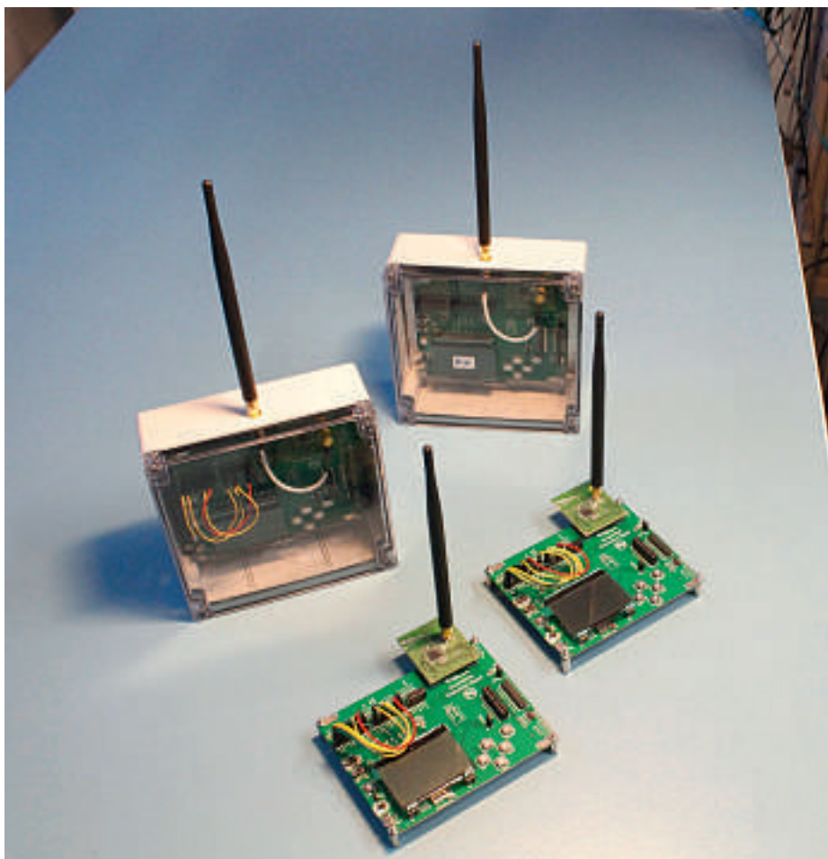
Ein Sensornetzwerk mit mehreren TI-CC1310-Entwicklungsboards zeigte im Labor, dass für den Betrieb eines Sensors bei 14-dBm-Sendeleistung 1 mW Energie ausreicht
