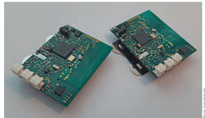
Smart Device: SmartConnector von Noser, Connectivity via BLE, Schnittstellen für Sensorik
