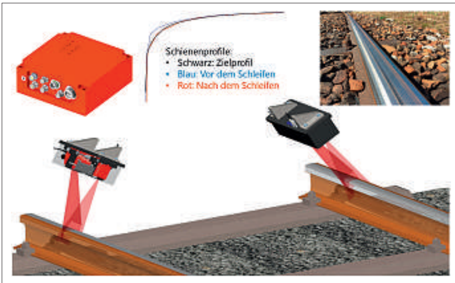
Zwei Laserscanner (unten) sind mit dem Hauptrechner (mitte oben) verbunden und werden von einer Embedded-CPS-Plattform (CPS = Cyber-Physical-System) basierend auf dem System-On-Module (SOM) gesteuert
