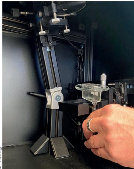
Das visuelle Inspektionssystem von 42 Technology nutzt eine spezielle Ausrichtung von kollimiertem Licht, Optik und einer Kamera und wurde bereits in die Sensorproduktionslinie von Inficon integriert.
