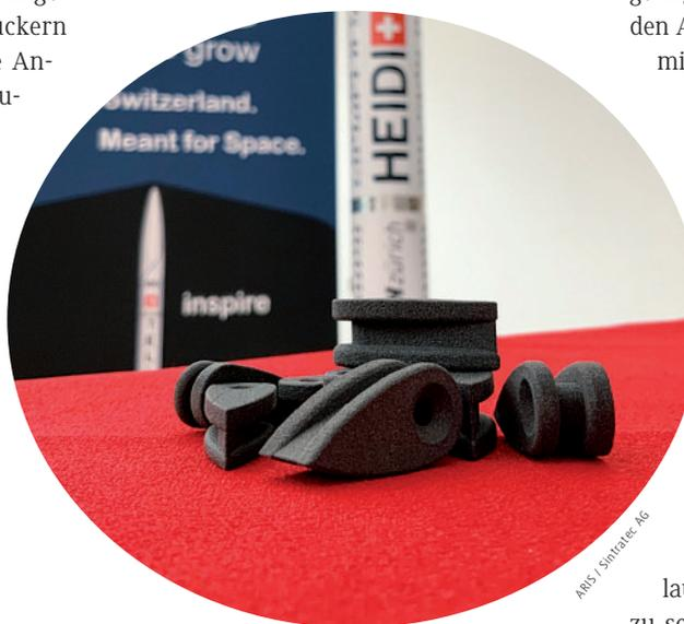
Die sogenannten Launch Lugs wurde vom Team EULER entwickelt und zuerst in FDM 3D-gedruckt, dann von Sintratec aus stabilem Polyamid-12 Pulver gesintert.
