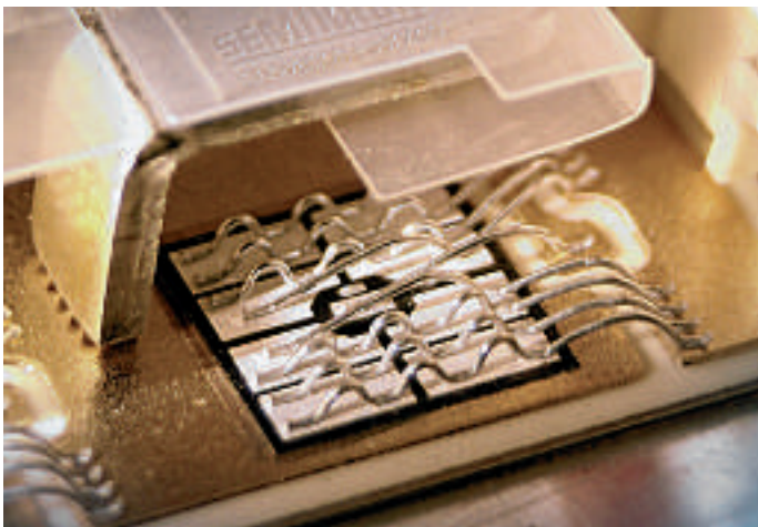
Bild 1: Die SKiiP-Module der vierten Generation: fünffach höhere thermische Lastwechselfestigkeit durch die Silber-schicht
