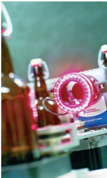
Beleuchtungsregelung mit einer Smart-Camera
