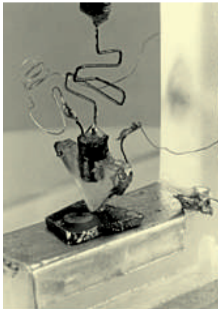
Erster Transistor – 1947 hergestellt in den Bell Laboratories
