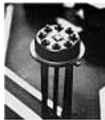
1968, im «Geburtsjahr» von Polyscope, stellt National Semiconductor mit dem LM100 seinen ersten integrierten Schaltkreis (IC) vor
