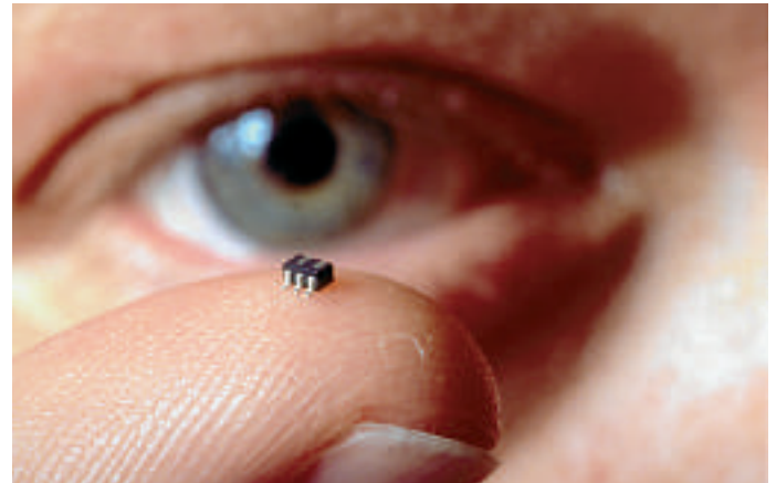
1998 präsentiert National unter der Bezeichnung LMV321 den weltweit kleinsten Operationsverstärker
