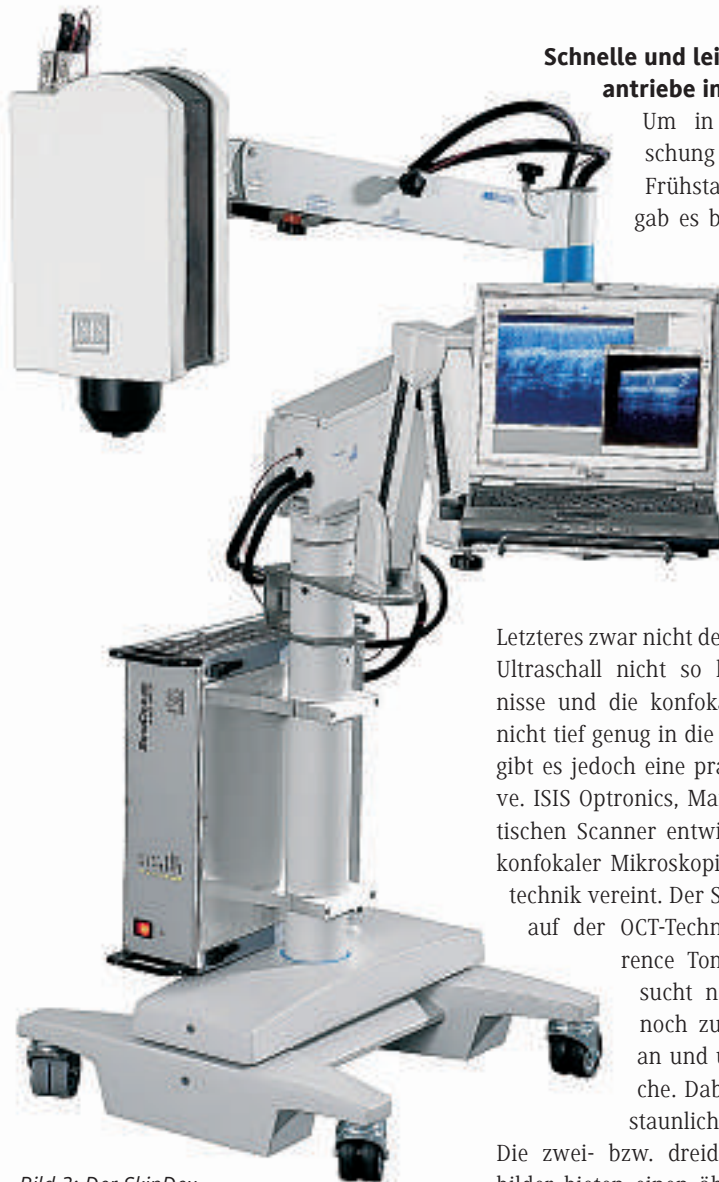
Bild 2: Der SkinDex basiert auf der OCT-Technologie (Optical Coherence Tomography) und untersucht nicht-invasiv und dennoch zuverlässig das Gewebe an und unter der Hautoberfläche
