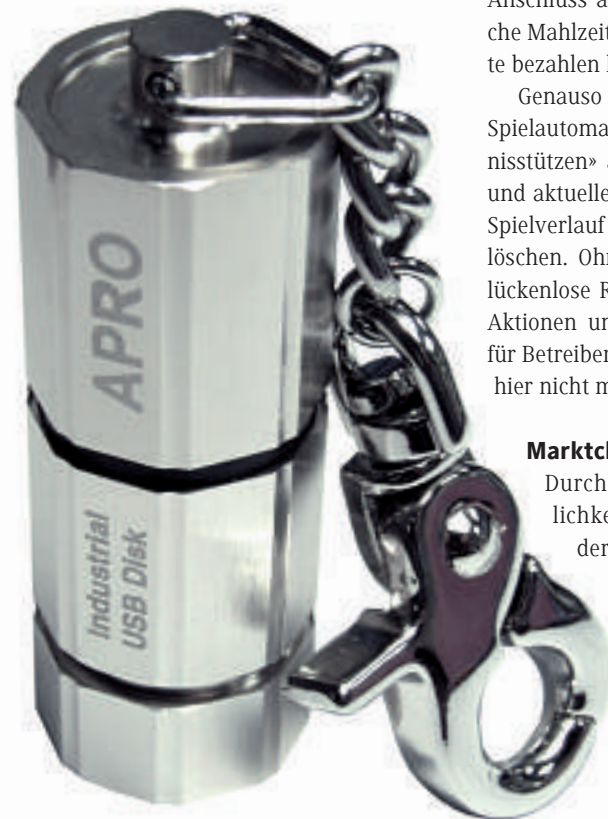
Die USB-Flash-Disks der Hammer-Serie sind ganz aus Metall, wasserdicht und halten Temperaturen von -40 bis +85 °C aus
