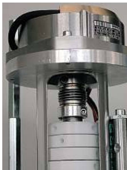
Endschaltergetriebe ersetzen eine Anzahl Linearendschalter, welche z. B. verschiedene Positionen einer Maschinenbewegung definieren
