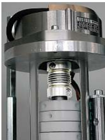
Endschaltergetriebe werden vorzugsweise in Werkzeugmaschinen und automatisierten Fertigungseinrichtungen eingesetzt
