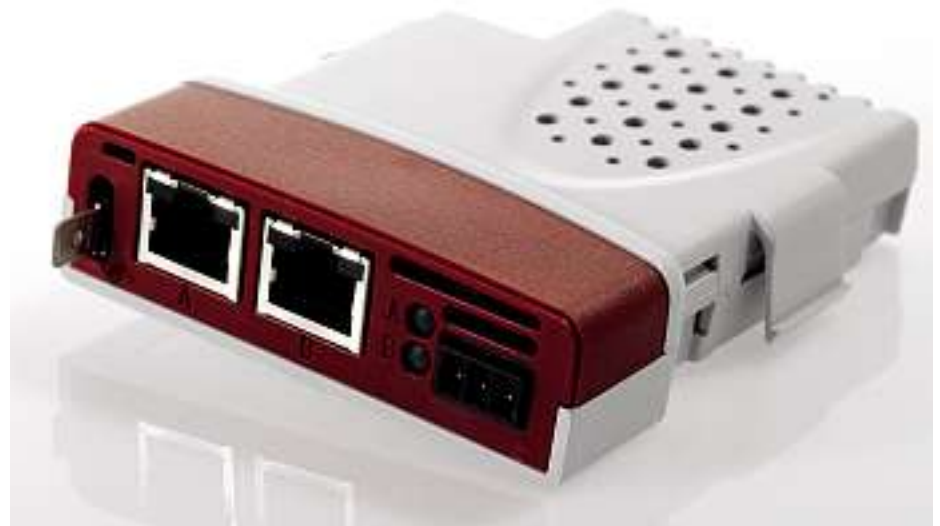
Das Modul kann alle 250 µs zyklische Daten von fünf 32-Bit-Parametern lesen und schreiben
