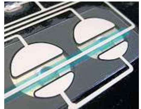
Bild 5: Praktische Ausführung von PushGate-Kontakten (Ansicht von unten)
