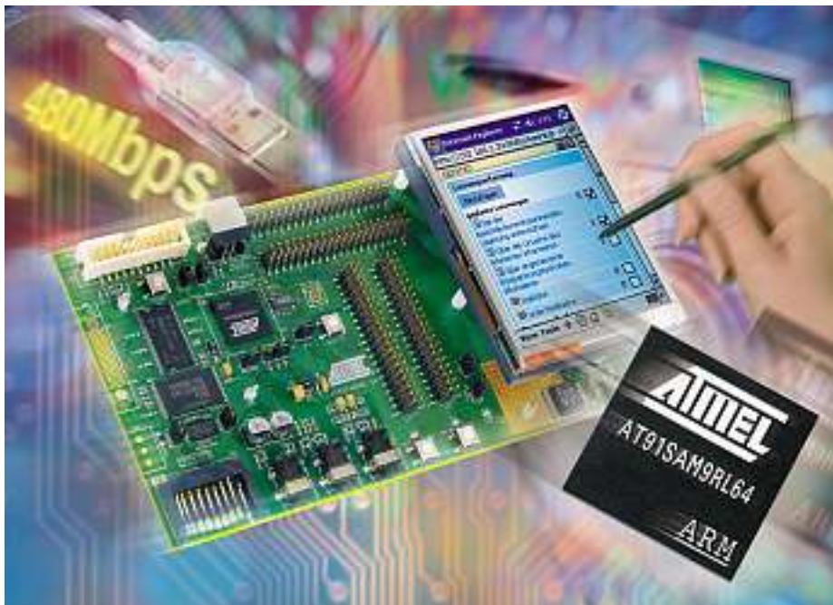
MSC bietet für jede Atmel-32-Bit-MCU eine preiswerte Referenzplattform mit Onboard-Display-Modul, ausreichend Memory, JTAG-Interface und umfangreiche Linux-BSPs
