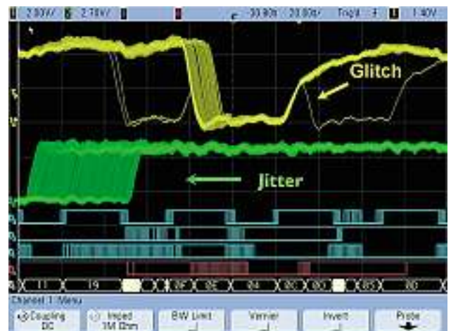
Bilder 2 und 3: Bildschirmanzeigen von Mixed-Signal-Oszilloskopen sollten hinterfragt werden. Der Bildschirm links (Bild 2) zeigt nur eine unvollständige Darstellung der Realität. Im Bild 3 zeigt das Agilent-Oszilloskop die reale Situation mit Jitteranteil und Glitch. Diese Echtzeit-Darstellung der effektiven Signalverhältnisse ist nur dank hoher Signalerfassungsraten und schneller Signaldecodierung möglich
