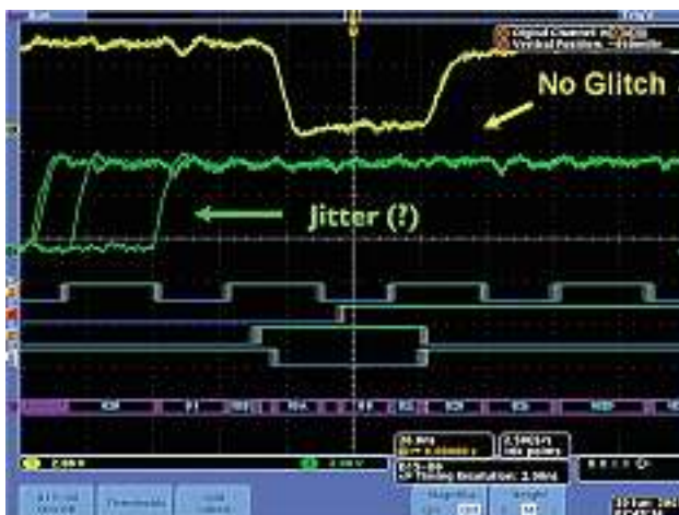
Bilder 2 und 3: Bildschirmanzeigen von Mixed-Signal-Oszilloskopen sollten hinterfragt werden. Der Bildschirm links (Bild 2) zeigt nur eine unvollständige Darstellung der Realität. Im Bild 3 zeigt das Agilent-Oszilloskop die reale Situation mit Jitteranteil und Glitch. Diese Echtzeit-Darstellung der effektiven Signalverhältnisse ist nur dank hoher Signalerfassungsraten und schneller Signaldecodierung möglich
