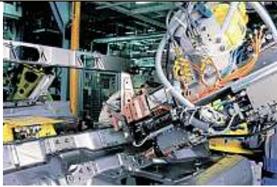
Beim Stumpfschweissen von Gewindebolzen an die PW-Karosserie übernimmt das Vision-System die Kontrolle von Schweißnähten und die Steuerung des Roboters (links). Im Bild rechts die kompakte Vision-Einheit, bestehend aus einer Pictor-Smart-Camera, einem telezentrischen Objektiv, einer Ringbeleuchtung und einem Objektivhalter auf einer Montageplatte (Quelle: Vision & Control)
