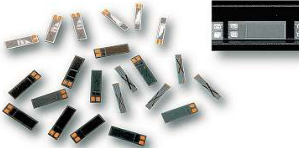
Links im Bild Temperatursensoren für Ansaugluft im PW, rechts das durch die Kamera erstellte Prüfbild (Quelle: Vision & Control)
