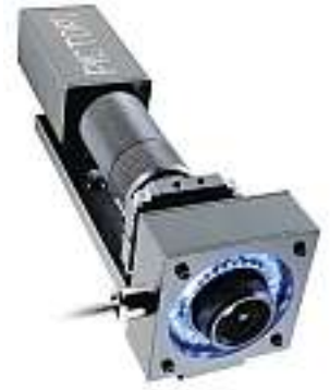
Beim Stumpfschweissen von Gewindebolzen an die PW-Karosserie übernimmt das Vision-System die Kontrolle von Schweißnähten und die Steuerung des Roboters (links). Im Bild rechts die kompakte Vision-Einheit, bestehend aus einer Pictor-Smart-Camera, einem telezentrischen Objektiv, einer Ringbeleuchtung und einem Objektivhalter auf einer Montageplatte (Quelle: Vision & Control)
