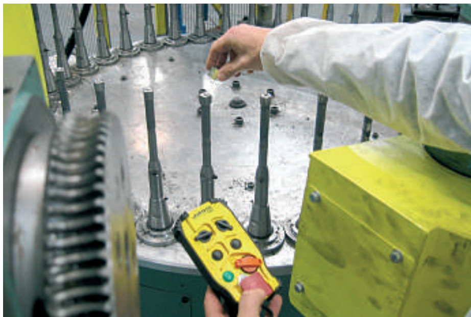
Bild 3: Da ausser dem Not-Aus-Schlagtaster bis zu vier weitere, frei konfigurierbare Taster oder Schalter auf dem Handsender Platz finden, kann der Bediener alle für ihn wichtigen Maschinenfunktionen auf die Ferne steuern, wenn die Maschine im Handmodus läuft
