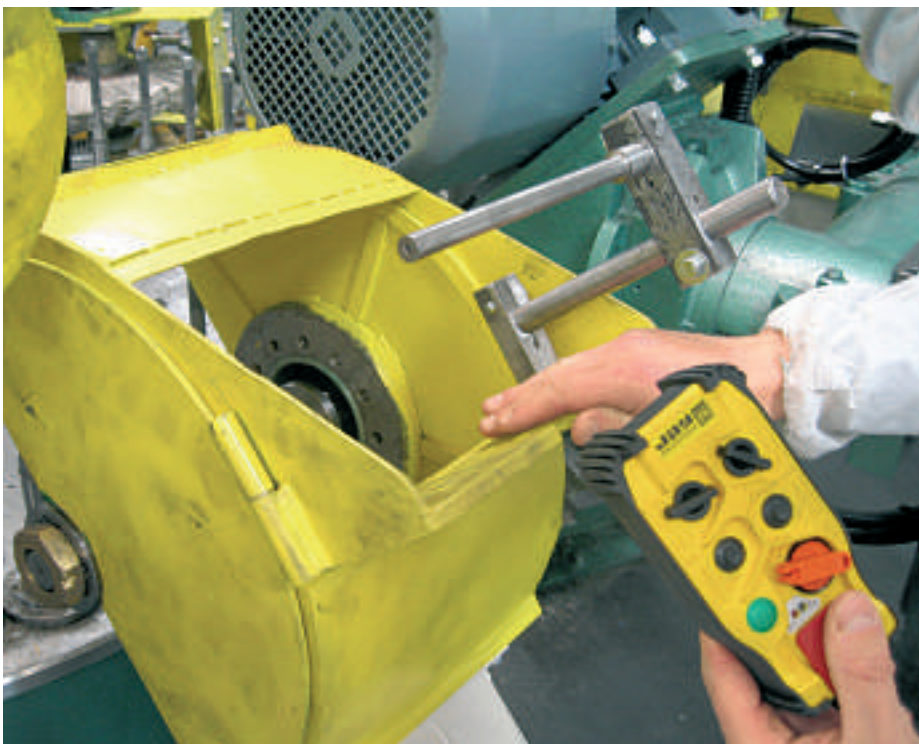
Bild 2: Der ergonomisch geformte Sender ist leicht, kompakt und lässt sich problemlos mit einer Hand bedienen
