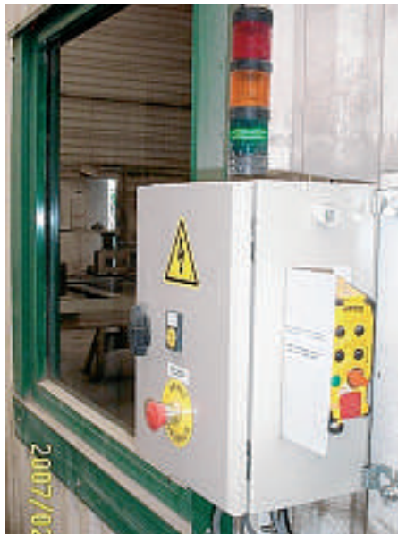
Bild 4: Nur wenn der Sender aus der Ladehalterung entnommen ist, lässt sich der manuelle Wartungsmodus der Maschine starten. Umgekehrt ist der «normale» Automatikbetrieb nur möglich, wenn sich der Handsender auf der Ladehalterung befindet
