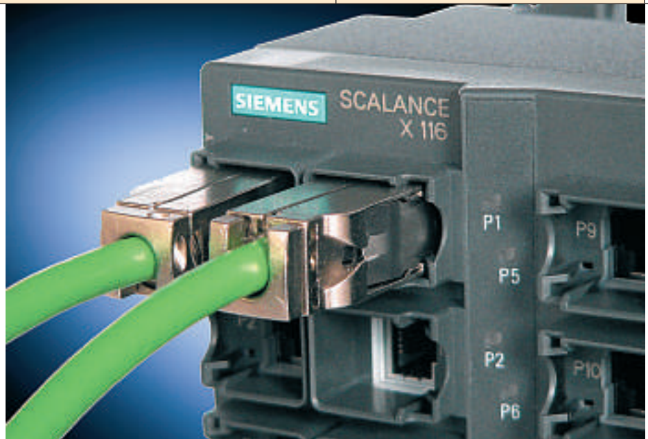
Durch das Zusammenspiel von Haltekragen und RJ45-Plug wird die RJ45-Buchse des Switches von Zug- und Biegebeanspruchungen entlastet
