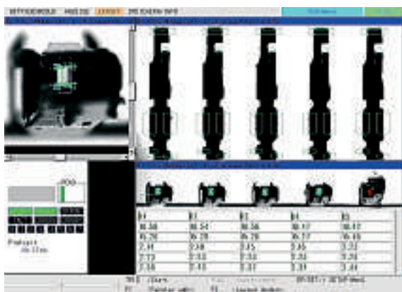
Bild 2: Präzise und schnelle Vermessung von Steckkontakten mit zwei Kameras
