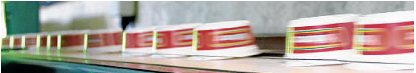
Nach dem Offset-Beducken laufen bis zu 260 Becher pro Minute mit der Oberseite nach unten über ein Förderband zur Stapelstation
