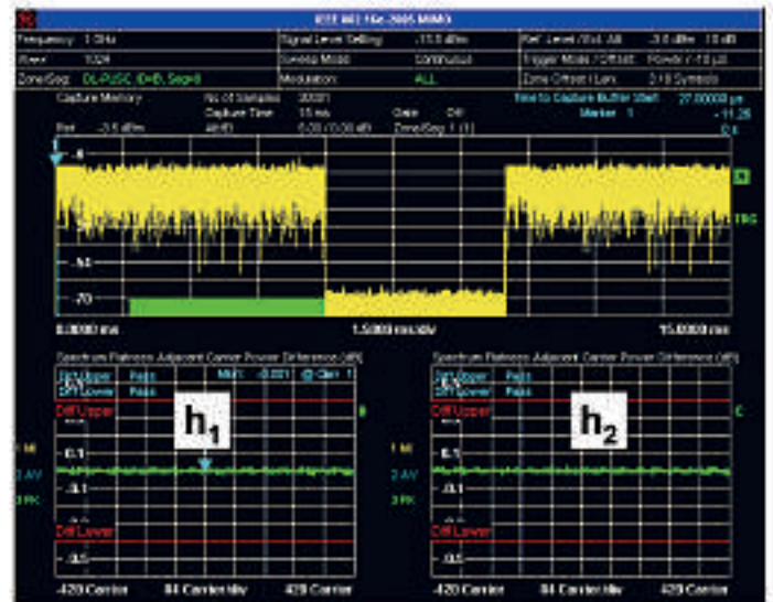
Bild 3: Zu den Ergebnissen der WIMAX-Option werden zusätzliche Ergebnisse angezeigt, wie hier die Spektrum-Flatness für die beiden Kanäle h1 und h2
