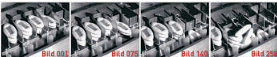
Die «Highspeed-Image-Streaming»-Plattform Promon zerlegt schnelle Vorgänge in bis zu 200 Bilder/s und erlaubt so eine zielgerichtete Fehlersuche bzw. Prozessoptimierung
