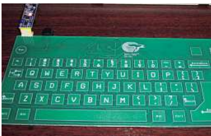
Bild 4: CapSense-Matrix-Tastefeld mit I 2 C-USB-Brücke
