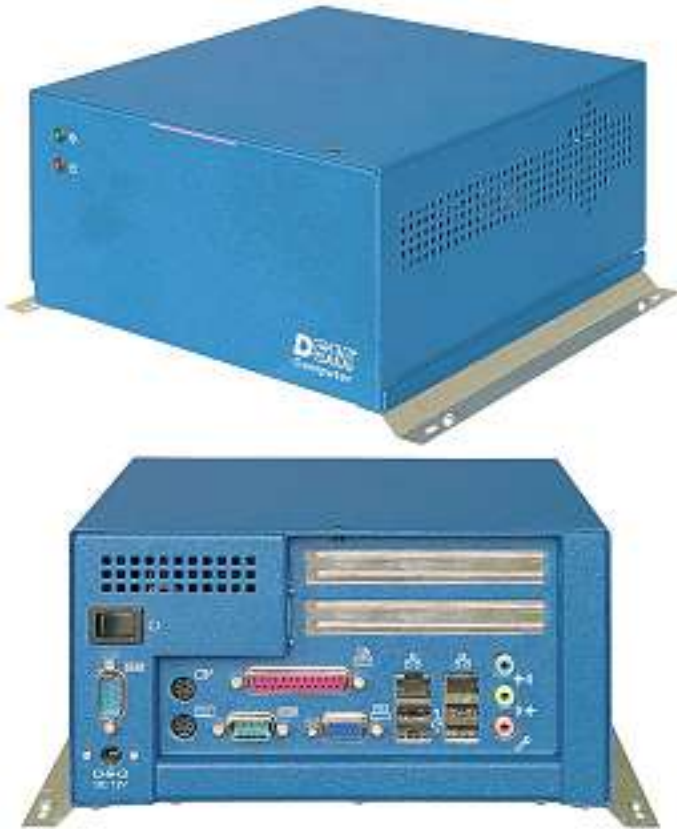
Die kundenspezifische Version des NanoServers im blanken Industriegehäuse
