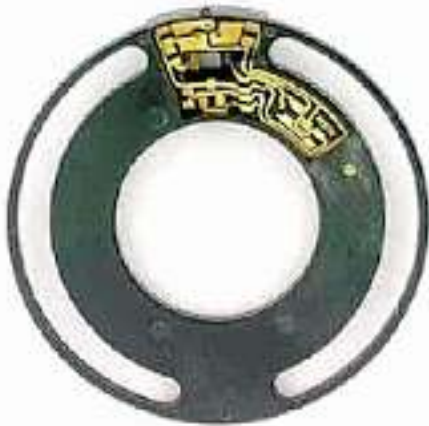
MID-Kunststoffteil eines Drehgebers mit elektrischer Schaltung (Quelle: HSG-IMAT, Festo)
